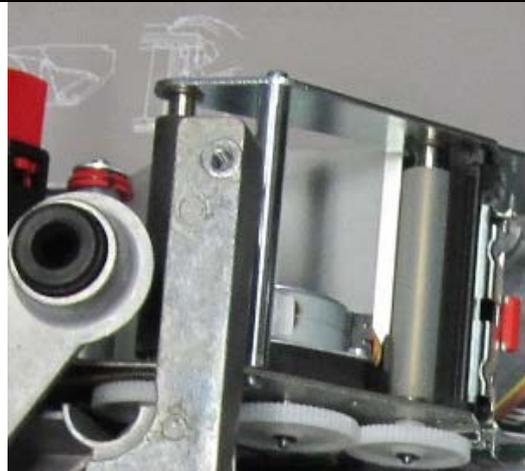
♦ Привод на основе ременной передачи – высокая надежность, не требует регулировок на протяжении срока службы. Конструкция отлично себя зарекомендовала на моделях SM-80/90/500.
